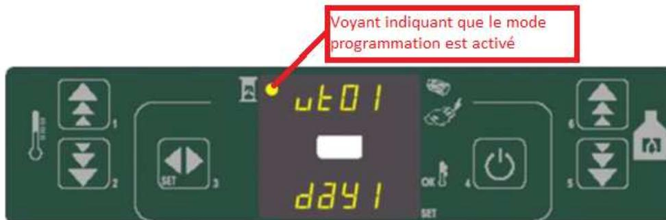
En faisant défiler le paramètre ut01 sur OFF le voyant du mode programmation s'éteint, l'accès aux plages de programmations n'est ensuite plus accessible l'appareil ne tiendra donc plus compte des éventuelles programmations ayant été réalisées. Pour réactiver la programmation refaire défiler le paramètre et se remettre sur le jour en cours.
