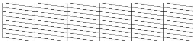
Si aucun segment des lignes imprimées ne manque, comme illustré ci-dessous, cela peut indiquer une buse d'encre obstruée ou une tête d'impression mal alignée.
