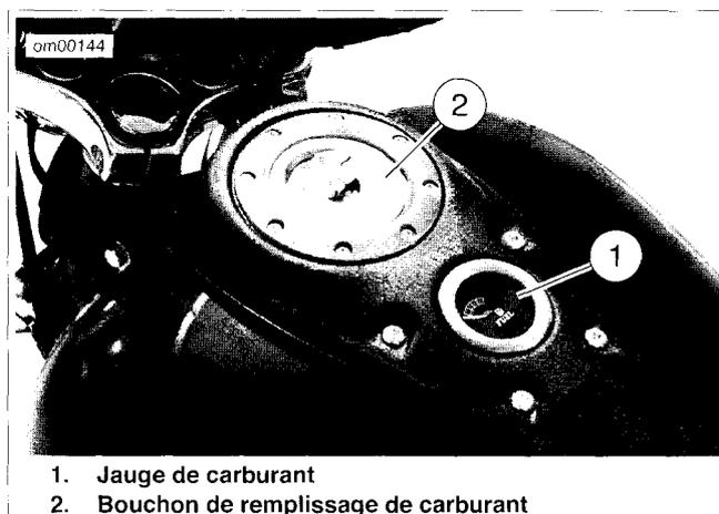
Figure 11. Jauge de carburant et bouchon de remplissage de carburant : modèle FXD
