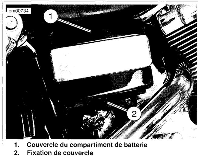
Figure 44. Compartiment de batterie : modèles Dyna
