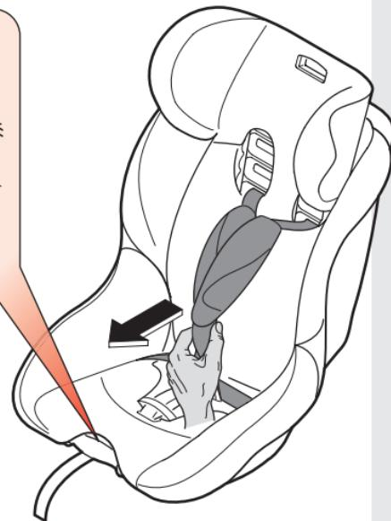
En la parte delantera de la silla, debajo de la funda, se encuentra el regulador central, que fija el cinturón central. Suelte el regulador central elevando con los dedos la pequeña lengüeta (véase ilustración), y tire de los **cinturones** hacia delante (**¡No tire de las protecciones acolchadas!**).
