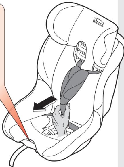
Voor aan de stoel onder de bekleding bevindt zich een centrale verstelling waarmee de centrale gordel is vastgeklemd.
