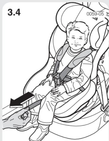
Tense todo el sistema del cinturón tirando del cinturón del regulador central hasta que el niño quede perfectamente sujetado. Tenga en cuenta que tanto la correa de hombros como las correas pélvicas estén tensadas homogéneamente. Para sacar al niño de la silla, apriete el botón rojo “Press” del cierre del cinturón situado en el sistema del cinturón de 4 puntos.
