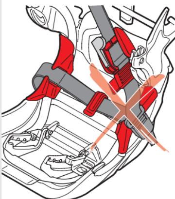
La chiusura della cintura di sicurezza del veicolo non deve essere più in alto della guida per la cintura ventrale. In caso di dubbi o problemi vi preghiamo di contattare la CONCORD.
