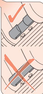
Enfilez la ceinture diagonale dans l'ouverture du cliquet, puis dans le guide sangle situé derrière.
