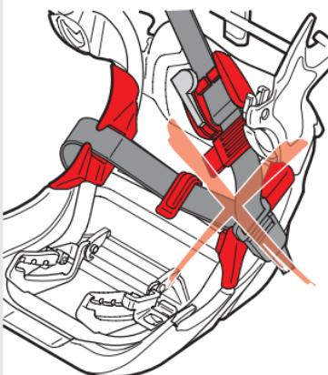
El cierre del cinturón de seguridad del coche no debe estar encima del extremo de la guía del cinturón pélvico. En caso de duda, o si algo no le queda claro, le rogamos que se ponga en contacto con la empresa CONCORD.
