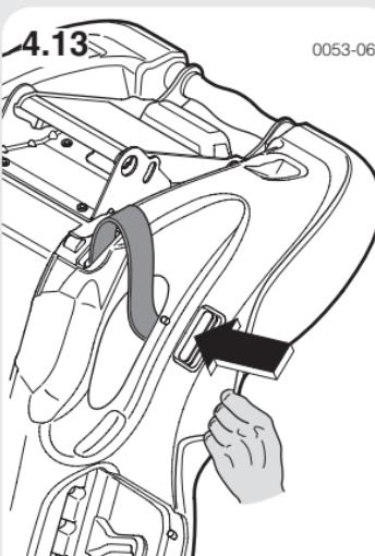
Extraiga de la base la carcasa de la silla y coloque la carcasa al revés sobre una base. Suelte la cinta elástica de la funda aflojela un poco. Suba los herrajes del cinturón que están insertados en el lateral de la carcasa y empújelos hacia atrás a través de su orificio.
