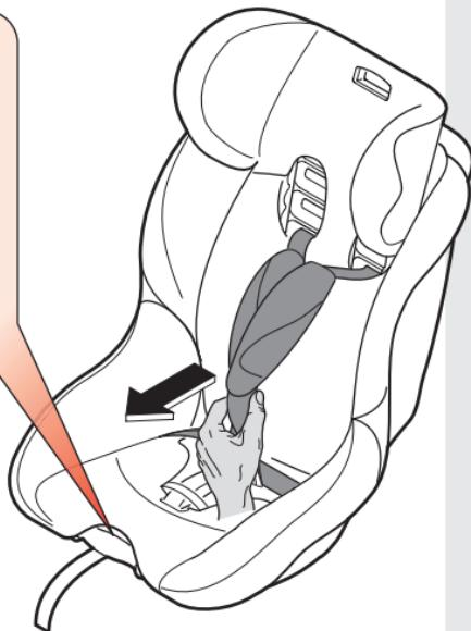
Sul davanti del sedile, sotto il rivestimento, si trova il dispositivo di regolazione centrale che regola la tensione delle cinture del seggiolino.
