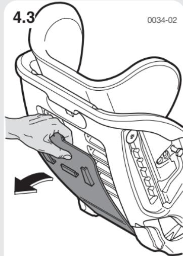
Voor het aanpassen van de schoudergordelposities moet de zitschaal van het basiselement worden verwijderd (zie 1.1 en 1.2)!
