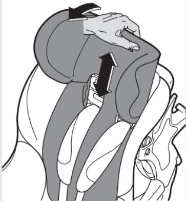
Fassen Sie die Kopfstütze oben an und ziehen Sie diese nach vorne. Sie können sie dann in die für Ihr Kind richtige Höhe einstellen. Es sind sechs unterschiedliche Positionen möglich.
