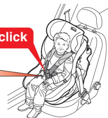
Junte ambas partes del cinturón (véase ilustración) y haga que encjen en el cierre del cinturón oyéndose un “clic”.
