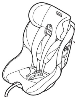
Extraiga de sus orificios los dos herrajes del respaldo del asiento con ayuda de las presillas, e introduzcalos en la carcasa a través de las aperturas del cinturón.
