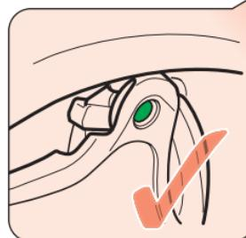
Quando il sedile a guscio è montato sulla base, controllate che su entrambi i lati si veda un **punto verde** in corrispondenza delle aperture laterali. Soltanto in questo caso il montaggio è corretto.
