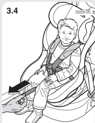
Tirare la cintura del dispositivo di regolazione centrale finché le cinture sono ben tese e il bambino è allacciato saldamente. È importante che sia le cinture per le spalle, sia quelle per il ventre siano tese in modo saldo e uniforme. Per estrarre il bambino, premere il tasto rosso con la scritta "Press" situato sulla chiusura che unisce le cinture per le spalle.
