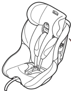
Trek nu de twee beslagelementen in het ruggedeelte van de stoel uit hun uitsparingen met behulp van de twee gordellussen en steek deze door de gordelopeningen in de zitschaal.
