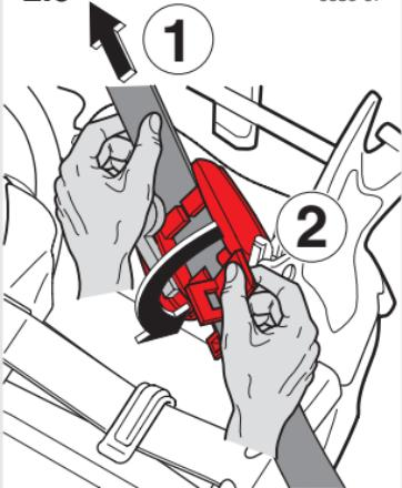
Tense (1) el cinturón superior ligeramente y cierre la pinza roja del cinturón (2). A continuación, vuelva a tensar el cinturón.
