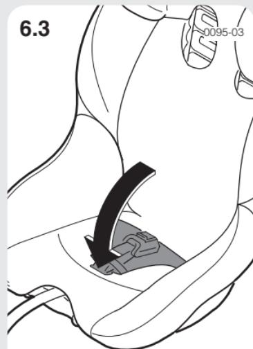
Sfilare l'imbottitura che riveste la chiusura della cintura ed estrarre la chiusura tirandola dal basso e facendola passare attraverso il rivestimento.
