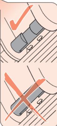
Far ruotare il tendicintura in modo che si veda l'apertura per la cintura.
