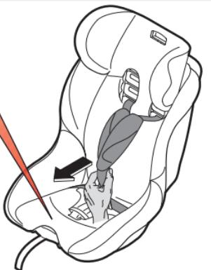
Sul retro del sedile, sfilare entrambe le cinture dall'elemento di collegamento.
