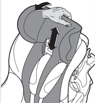
Tome el reposacabezas por la parte superior y tire hacia adelante. Ahora puede ajustarlo a la altura adecuada para su niño. Se puede colocar en seis posiciones diferentes.
