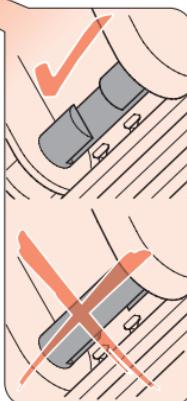
Coloque o cinto superior (cinto diagonal) na abertura da catraca e na guia posterior.
