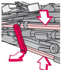
Ouvrez tout d'abord le verrouillage de transport en pressant les tubes et en déplaçant le levier du verrouillage de transport (11) vers l'extérieur.
