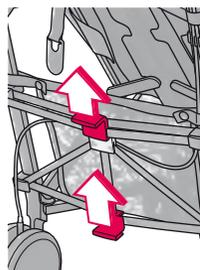
Déplacez simultanément les boutons de commande TWINLOCK supérieurs et inférieurs (12) vers le haut et rabattez les deux poignées-étriers (01) du CONCORD QUIX ensemble, vers l'avant et le bas.
