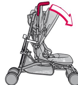
Repliez totalement le CONCORD QUIX jusqu'à ce que le verrouillage de transport (11) s'enclenche audiblement.
