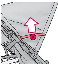
Pour la débloquer, enfoncez les systèmes de verrouillage sur les deux côtés de la protection solaire vers le haut.
