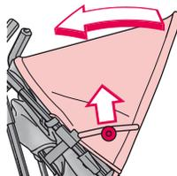
pliez la partie avant de la protection solaire vers l'intérieur et rabattez complètement la protection solaire vers l'arrière.
