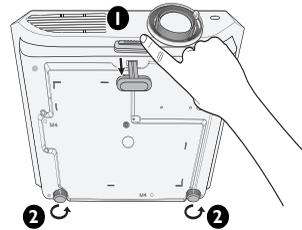
Pour rentrer le pied de réglage, soulevez le projecteur et appuyez sur le bouton à dégageur rapide. Ensuite, reposez lentement le projecteur. Dévissez le pied de réglage arrière dans la direction inverse.
