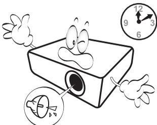
9. Ne remplacez jamais la lampe ni aucun composant électronique tant que le projecteur n'est pas débranché.
