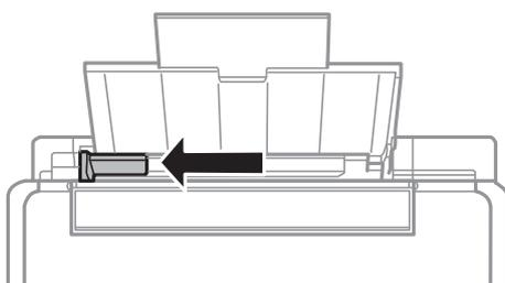
3. Chargez le papier verticalement le long du côté droit de l'alim. papier arrière avec le côté imprimable orienté vers le haut.
