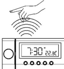
Passer la main sur le capteur pour activer la fonction "SNOOZE" ("REPETITION ALARME")
