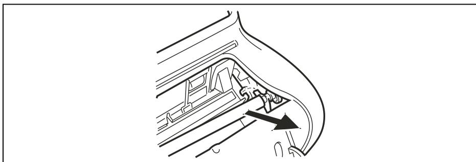
6. Nettoyez le miroir du lecteur optique avec un **chiffon imbibé** d'un produit de nettoyage pour les vitres, puis essuyez-le soigneusement.
