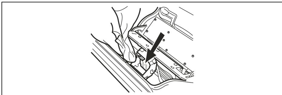
7. Réinsérez la cartouche d'impression dans le logement, avec les contacts électriques orientés vers le bas.
