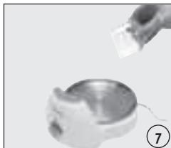
8. Dan de bak zorgvuldig terugzetten op het voetstuk, controleer zorgvuldig of de rand van de bak goed aansluit op het verwarmende voetstuk van staal.
