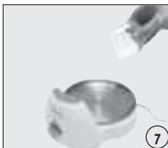
7. Odeberte dávkovací nádobu z kontrolní konzoly a 2x ji naplňte, aby se naplnilo přibližně 60 ml studené vody, která se poté nalije na ocelový podstavec.
