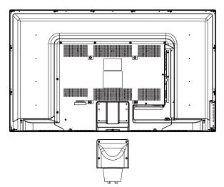
3. Utilisez les quatre vis fournies pour fixer le téléviseur sur un support mural (non inclus) par les quatre trous VESA standard à l'arrière du téléviseur.
