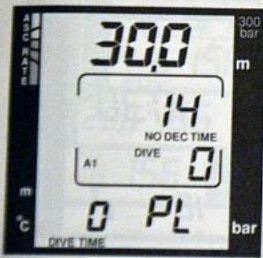
Fig. 3.8 PLANNING Le temps disponible sans décompression à 30 m est de 14 min en mode A1.
