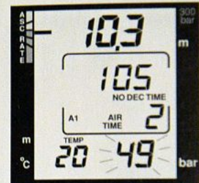
Fig. 3.15 INDICATEUR DE VITESSE DE REMONTEE Repère en position horizontale : vitesse de remontée entre 9 et 11 m/mn. BEEP
