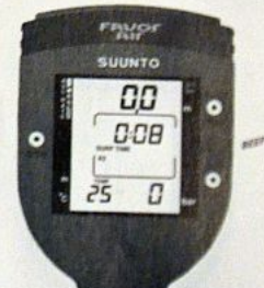
Fig. 4.11 REGLAGE D'ALTITUDE OU PERSONNALISE, phase 5 Retour au mode surface. Vérifier que le mode A sélectionné est bien affiché.
