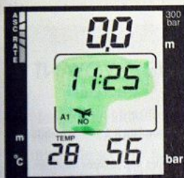
Fig. 3.23 MODE SURFACE APRES UNE PLONGEE, AFFICHAGE IL Le temps de désaturation/attente avant envol indiqué par le voyant non clignotant en forme d'avion est de 11 h 25 min. La profondeur est de 300 m et la température de 28°C.
