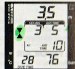
Fig. 3.18 PLONGEE AVEC DECOMPRESSION, DANS LA ZONE PLAFOND. Les deux flèches pointent l'une vers l'autre. Le plongeur est dans la zone plafond à 3.5 m - la durée minimum de la remontée est de 5 mn - la profondeur plafond est à 3 m.
