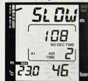
Fig. 3.16 INDICATEUR DE VITESSE DE REMONTEE Repère dirigé vers le haut : vitesse de remontée supérieure à 11 m/mn. La mention SLOW est affichée indiquant que la vitesse de remontée de 10 m/mn a été dépassée de façon prolongée. Il faut ralentir.
