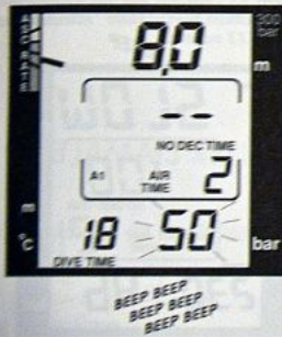
Fig. 3.14 ALARMES PRESSION D'AIR La pression est arrivée à 50 bar. L'affichage de la pression clignote et trois doubles bips retentissent.
