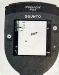
Fig. 4.10 REGLAGE D'ALTITUDE OU PERSONNALISE, phase 4 Le mode choisi, A2, est verrouillé en touchant les contacts TIME/MODE et COM.
