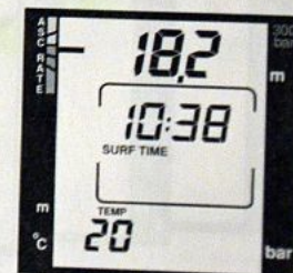
Fig. 4.3 CARNET DE PLONGEE, AFFICHAGE II La profondeur moyenne de la plongée était de 18,2, l'intervalle surface avant la plongée 10 h 38 mn et la température à la profondeur maximum 20°C.
