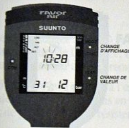
Fig. 4.12 REGLAGE DE L'HEURE ET DE LA DATE Prêt pour le réglage de l'heure (les heures clignotent).
