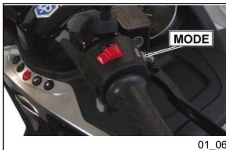
Le véhicule dispose de trois boutons principaux pour la navigation de l'afficheur numérique :
