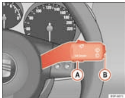
Fig. 42 Levier de l'essuie-glace : la touche A sert à confirmer les options du menu et la commande à bascule B permet de changer de menu
