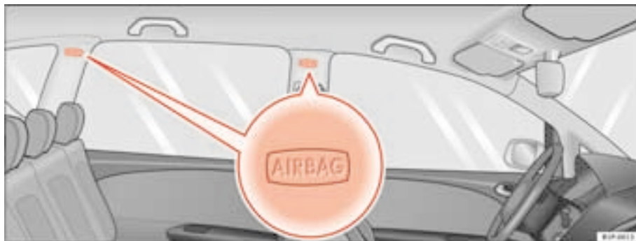
Fig. 23 Emplacement de montage des airbags de tête du côté gauche du véhicule
