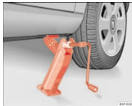
Fig. 154 Mise en place du cric
