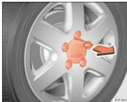
Fig. 151 Changement de roue : enlever l'enjoliveur de la roue
