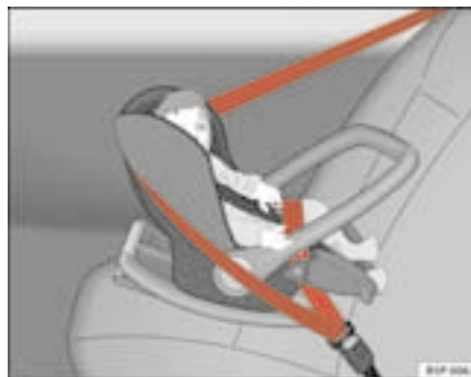
Fig. 27 Siège pour enfants du groupe 0 monté à l'arrière dos à la route
