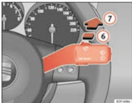
Fig. 84 Levier d'essuie-glace et de lave-glace : essuie-glace de glace arrière
