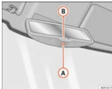
Fig. 85 Rétroviseur intérieur avec réglage automatique de position anti-éblouissement.
