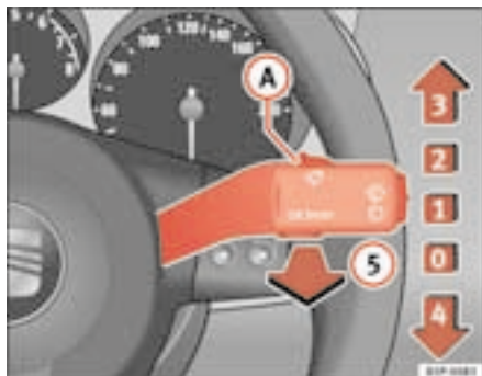
Fig. 81 Levier d'essuie-glace et de lave-glace
