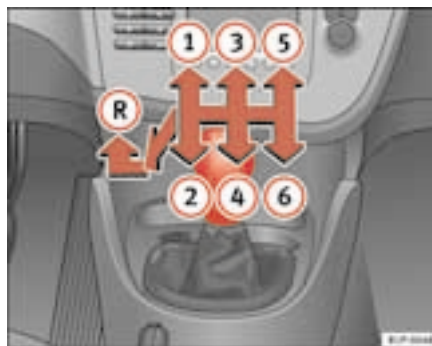
Fig. 115 Détail de la console centrale : grille des vitesses de la boîte mécanique à 6 vitesses ▶
