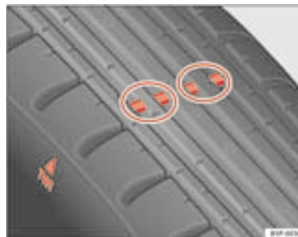
Fig. 148 Sculptures du pneu : indicateurs d'usure
