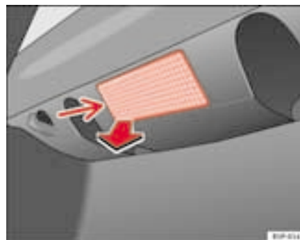
Fig. 171 Feu du coffre à bagages
