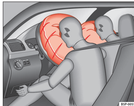
Fig. 18 Schéma de principe : airbags frontaux gonflés
