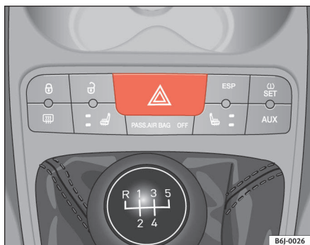
Fig. 54 Console centrale : touche d'activation des feux de détresse
