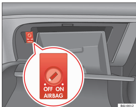
Fig. 23 Dans la boîte à gants : contacteur à clé pour activer et désactiver les airbags côté passager
