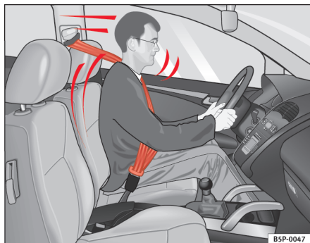
Fig. 10 Conducteur correctement sanglé, retenu par sa ceinture de sécurité en cas de freinage brusque
