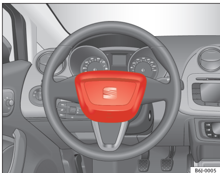
Fig. 16 Airbag du conducteur dans le volant
