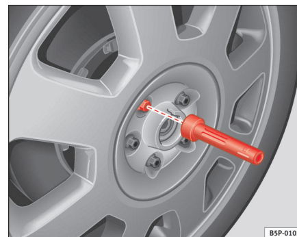
Fig. 138 Changement de roue : outil à six pans creux pour tourner les boulons
