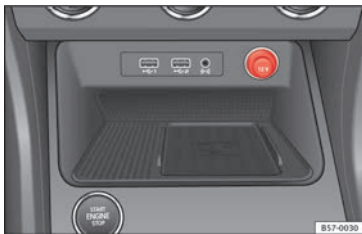
Fig. 148 Console centrale : prise de courant de 12 volts
