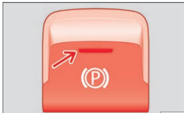
Fig. 165 Sur la partie inférieure de la console centrale : touche du frein de stationnement électronique.
