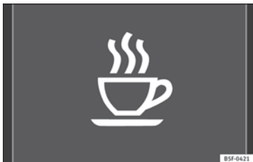
Fig. 199 Sur l'écran du combiné d'instruments : symbole de détection de la fatigue.
