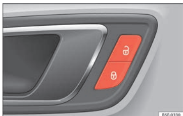
Fig. 2 Porte du conducteur : commande de verrouillage centralisé.
