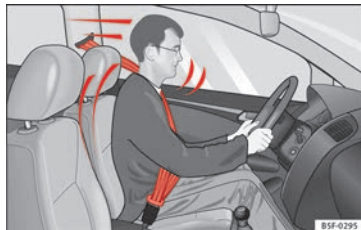
Fig. 87 Les conducteurs qui ont correctement bouclé leur ceinture de sécurité ne seront pas projetés en cas de freinage soudain.
