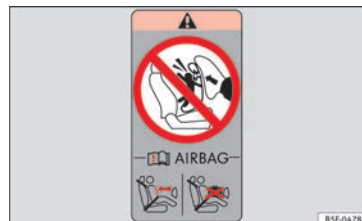
Fig. 29 Sur le cadre arrière de la porte du passager : autocollant concernant l'airbag.
