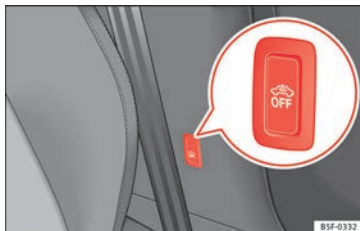
Fig. 128 Touche de protection volumétrique/de protection anti-soulèvement.
