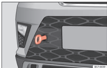
Fig. 74 Pare-chocs avant droit : œillet de remorquage vissé
