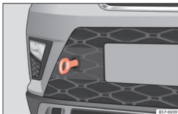
Fig. 97 Du côté droit du pare-chocs avant : œillet de remorquage vissé
