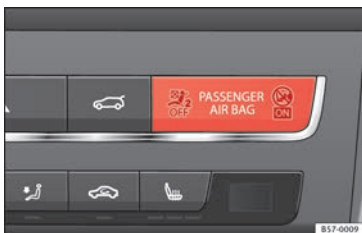
Fig. 51 Témoin de désactivation de l'airbag du passager.
