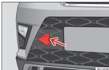
Fig. 96 Du côté droit du pare-chocs avant : retirer le cache.
