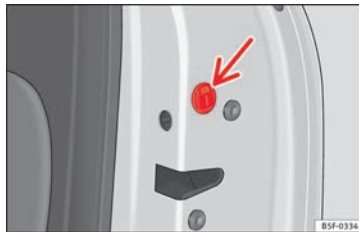
Fig. 4 Verrouillage d'urgence de la porte.
