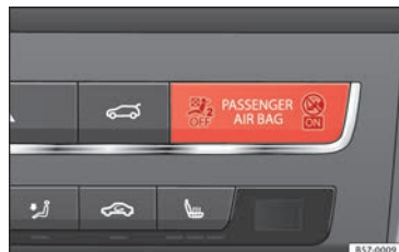
Fig. 92 Témoin de contrôle sur la planche de bord indiquant la désactivation de l'airbag frontal du passager avant.
