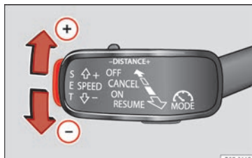
Fig. 179 À gauche de la colonne de direction : troisième levier pour utiliser le régulateur de vitesse adaptatif.
