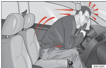
Fig. 88 Le conducteur n'ayant pas bouclé sa ceinture est projeté en avant.
