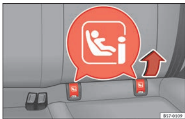
Fig. 31 Anneaux de fixation ISOFIX/iSize.
