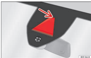
Fig. 191 Sur le pare-brise : fenêtre de l'assistant de maintien de voie.
