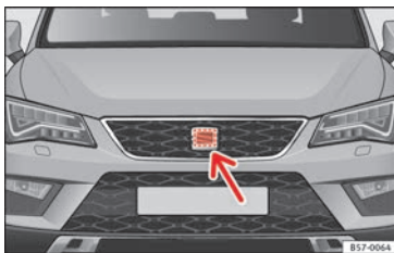
Fig. 177 Sur la face du véhicule derrière l'émblème SEAT : capteur radar.
