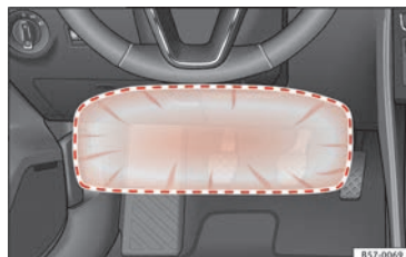
Fig. 24 Côté conducteur : rayon d'action de l'airbag de genoux.
