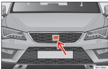
Fig. 185 Sur la face du véhicule derrière l'emblème SEAT : capteur radar.
