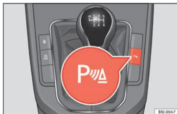
Fig. 216 Console centrale : touche de l'aide au stationnement.
