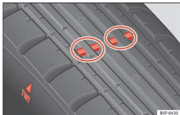
Fig. 239 Sculptures du pneu : indicateurs d'usure.
