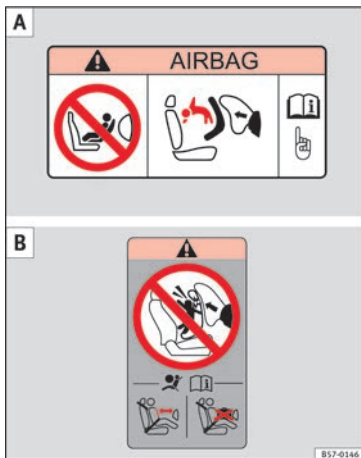
Fig. 28 Autocollant de l'airbag - version 2 : sur le pare-soleil côté passager A et sur le cadre arrière de la porte du passager B .
