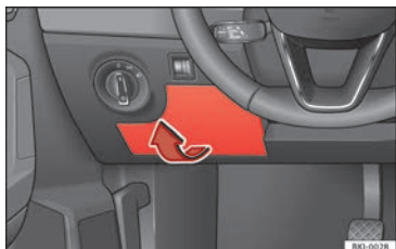
Fig. 69 Sur le tableau de bord côté conducteur : cache du boîtier de fusibles.
