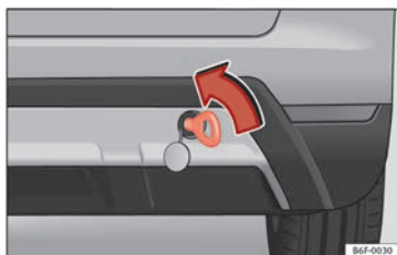
Fig. 108 Pare-chocs arrière droit : œillet de remorquage vissé
