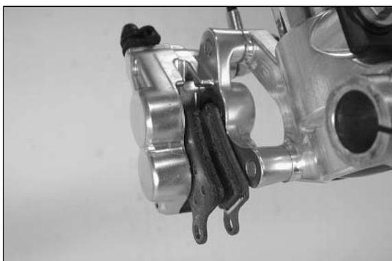
Mettre la plaquette droite et la tenir en place avec la vis. Mettre en place la plaquette gauche et serrer la vis à 4 Nm. Remettre la rondelle frein. Positionner les plaquettes et remonter la roue (cf. chapitre Pose de la roue avant).
