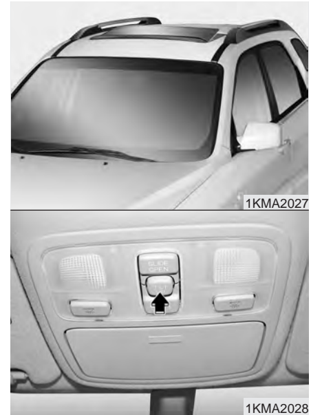
Entrebâillement le toit ouvrant
