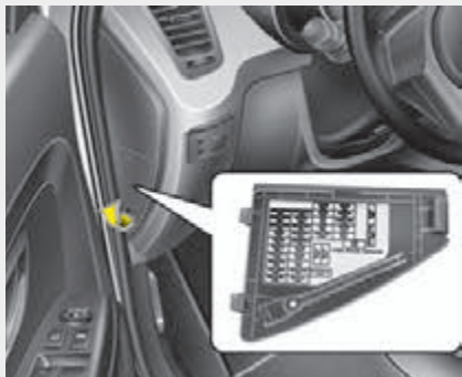
Panneau de fusibles intérieur
