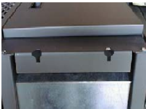
Photo 3: Fixation supérieure du panneau latéral
