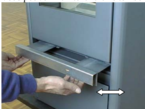
Photo 9: actionnement de la tirette de décendrage
