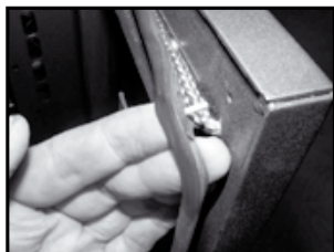
Illustration F10: Vérifiez le joint d'étanchéité de la porte de chargement.
