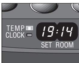
F: A la izquierda la temperatura deseada, a la derecha la temperatura existente
