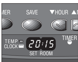
G: La lampe témoin TIMER indique que la fonction timer est active.
