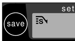
I: Si la lampe témoin SAVE s'allume, l'appareil s'allume et s'éteint automatiquement afin de rester dans les limites d'une certaine plage de températures.
