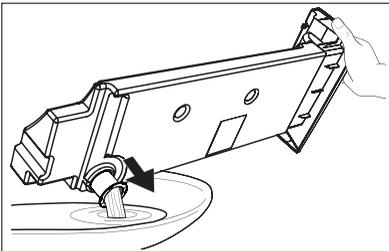
3. Sortez le raccord en plastique et vidangez le bac d'eau de condensation dans un évier ou un réceptacle équivalent.
