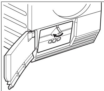
3. Tournez le loquet pour déverrouiller le capot du condenseur thermique.
