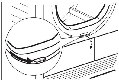
2. Déplacez le curseur de verrouillage situé en bas du hublot et ouvrez la porte du condenseur thermique.
