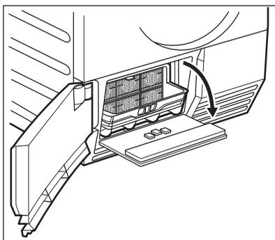
4. Abaissez le capot des filtres du condenseur thermique.
