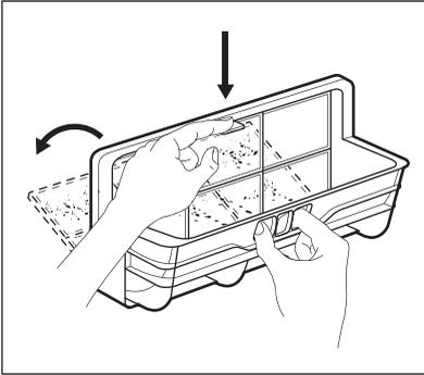
6. Poussez sur le crochet pour ouvrir le filtre.
