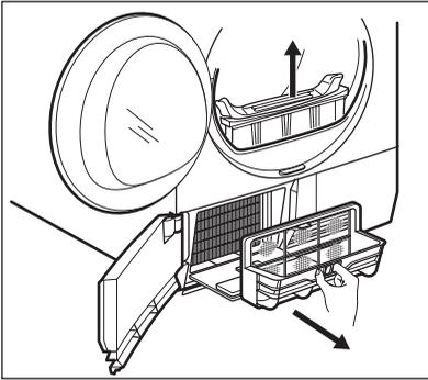
5. Soulevez le filtre principal. Tenez le filtre du condenseur thermique et sortez-le du compartiment inférieur.
