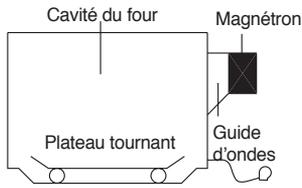
Dans un four à micro-ondes, l'électricité est convertie en micro-ondes par le MAGNETRON.
