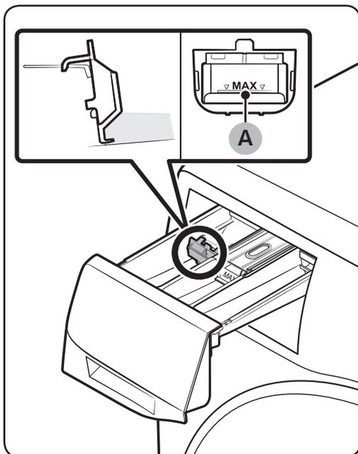
Insérez d'abord le réservoir pour liquide fourni dans le **II** compartiment de lavage principal. Puis mettez de la lessive liquide dans le réservoir en-dessous de la ligne max (A) indiquée.
