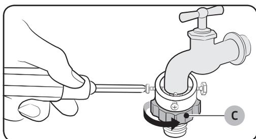
4. Insérez l'adaptateur dans le robinet d'eau, et resserrez les vis tout en levant l'adaptateur.
