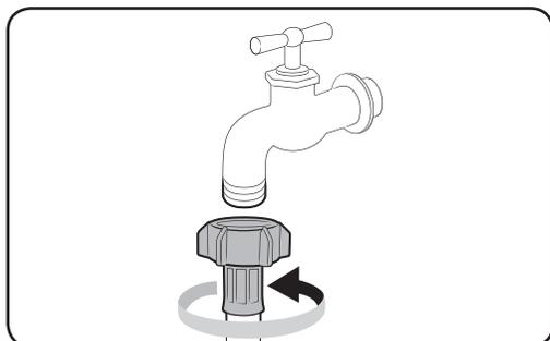
7. Si vous utilisez un robinet d'eau de type à vis, utilisez l'adaptateur de type à vis prévu pour être raccordé au robinet d'eau comme indiqué.
