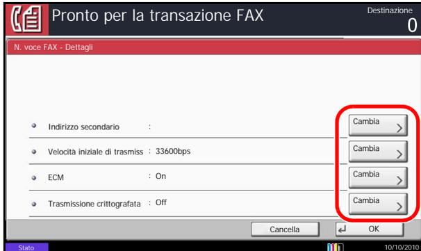
Premere [Dettagli]. Premere [Cambia] in corrispondenza dei singoli parametri, modificare le impostazioni e premere [OK]. Una volta completata la modifica delle impostazioni, premere [OK] e [Chiudi].
