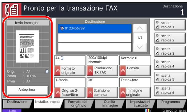
La seguente procedura mostra come sostituire la registrazione di *Densità* con *Zoom* sulla schermata *Installaz. rapida* per la comunicazione fax.
