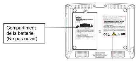
L'appareil possède une batterie intégrée rechargeable (lithium-ion polymère). Rechargez la batterie avant la première utilisation. Cela prend environ 4 heures pour recharger totalement la batterie.
