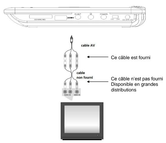
Utilisez le câble A/V pour relier l'appareil au téléviseur. Assurez-vous qu'il est correctement branché
