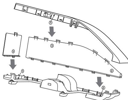
3. Insérez les trois boutons sur l'enveloppe de câble dans les trois orifices du projecteur tel qu'illustré sur la figure. Faites passer les câbles par les orifices sur la partie inférieure de l'enveloppe de câble.
