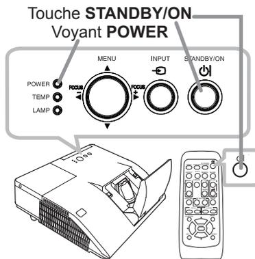
Ne pas remettre le projecteur sous tension avant que s'écoulent au moins 10 minutes avant la mise hors tension. Par ailleurs, n'éteignez pas le projecteur juste après l'avoir allumé. Cela risquerait de provoquer le dysfonctionnement de la lampe ou de raccourcir la durée de vie de certaines pièces, y compris la lampe.
