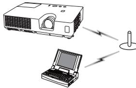
Fig. 1.4.1.b Communication avec un point d'accès (Infrastructure)
