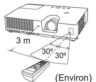
**REMARQUE** • Le signal de télécommande reflété sur l'écran ou autre peut être disponible. S'il est difficile d'envoyer un signal directement au capteur, essayez de réfléchir le signal.
