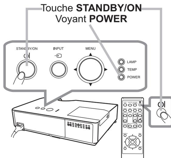
Ne pas remettre le projecteur sous tension avant que s'écoulent au moins 10 minutes avant la mise hors tension. Par ailleurs, n'éteignez pas le projecteur juste après l'avoir allumé. Cela risquerait de provoquer le dysfonctionnement de la lampe ou de raccourcir la durée de vie de certaines pièces, y compris la lampe.
