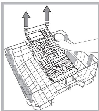
Le panier supérieur est réglable en hauteur selon les besoins : en position haute, il permet de ranger de la vaisselle encombrante dans le panier inférieur ; en position basse, il permet d'exploiter au mieux l'espace des clayettes et des secteurs rabattables en créant plus de place de rangement vers le haut.
