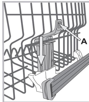
Si le panier est équipé de **Lift-Up\*** (voir figure), soulever le panier en le saisissant par les côtés et le déplacer vers le haut. Pour revenir à la position basse, appuyer sur les leviers (A) sur les côtés du panier et l'aider à descendre vers le bas.
