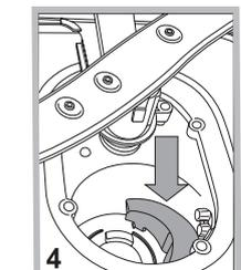
Après avoir nettoyé les filtres, remettre soigneusement le groupe filtrant à sa place, cette opération est fondamentale pour un bon fonctionnement du lave-vaisselle.
