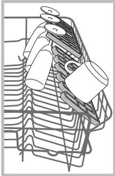
Les verres à pied peuvent être placés en position stable sur les clayettes rabattables en insérant la tige de leurs pieds dans les fentes prévues à cet effet. Pour optimiser le séchage, choisir la plus forte inclinaison des clayettes rabattables. Pour modifier l'inclinaison de la clayette rabattable, la soulever et la faire glisser légèrement avant de la placer comme voulu.
