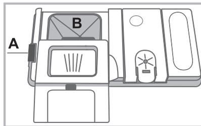
**Introduire le produit de lavage dans le bac « B » bien sec. La quantité de produit de lavage consacrée au pré-lavage doit être placée directement dans la cuve.**
