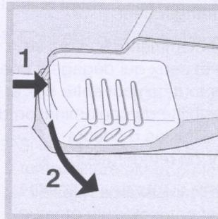
couvercle de protection comme illustré (voir figure). Remplacez-la par une ampoule semblable dont la puissance doit correspondre à celle indiquée sur le couvercle de protection (15 W ou 25 W).
