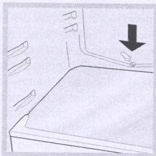
par un trou d'évacuation (voir figure) où la chaleur produite par le compresseur la fait évaporer. Il vous suffit de nettoyer périodiquement le trou d'évacuation pour permettre à l'eau de s'écouler normalement.
