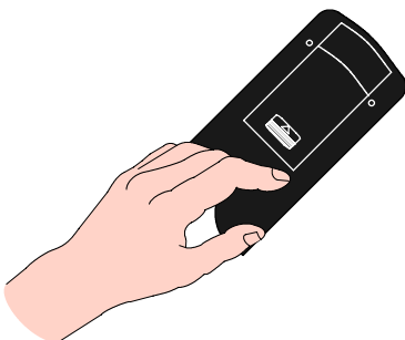
Deckel des Batteriefaches herausschieben
