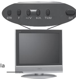
Capteur des signaux de la télécommande
