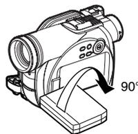
Si le moniteur d'affichage à cristaux liquides est pivoté sur 180° pour que l'écran soit orienté dans la même direction que l'objectif pendant l'enregistrement, l'image du sujet filmé apparaîtra également dans le viseur sous la forme d'une image miroir (inversion gauche – droite).
