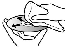
Utiliser le chiffon de nettoyage des disques pour nettoyer le disque, en essuyant la surface du centre vers la périphérie, ou utiliser une poire soufflante pour lentille d'appareil photo pour enlever la poussière.
