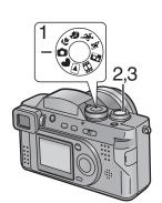
Nur durch Drücken des Auslösers wird die Belichtung (Verschlussklappen-Geschwindigkeit und Öffnungswert) automatisch reguliert und es wird fotografiert.
