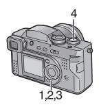
Durch einmalige Betätigung des Auslösers schießt die Kamera automatisch 3 Bilder, wobei die Belichtung entsprechend der eingestellten Werte für die Belichtungskompensierung ändert.
