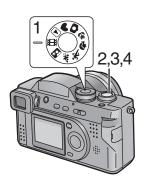
Mit dieser Kamera können Sie auch Laufbilder aufnehmen. (Bei Benutzung der beiliegenden 8MB SD Speicherkarte, können etwa 35 Sekunden aufgezeichnet werden)
