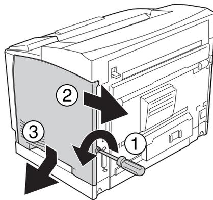
3. Desserrez les deux vis à l'aide d'un tournevis. Maintenez ensuite la patte située sur la partie supérieure du capot de protection et retirez le capot.
