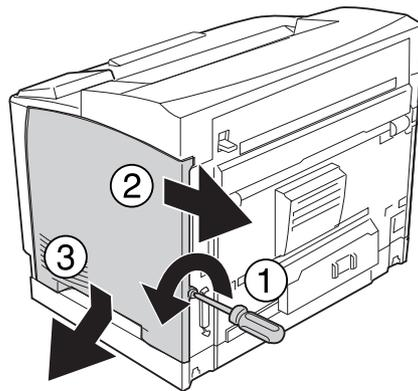
3. Desserrez les deux vis à l'aide d'un tournevis. Maintenez ensuite sur la patte située sur la partie supérieure du capot de protection et retirez le capot.
