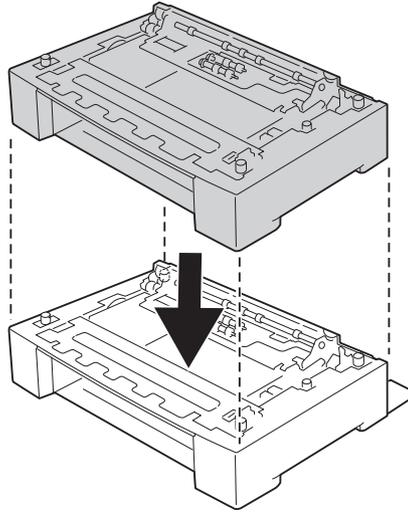
7. Fixez les unités papier optionnelles avec les quatre raccords. Installez deux des quatre raccords à l'intérieur, des deux côtés de l'unité papier optionnelle, et les deux autres raccords à l'extérieur, des deux côtés.
