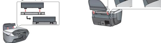
Remarque : La protection du bac feuille à feuille permet aux éléments placés sur le capot de ne pas tomber dans le combiné multifonction.
