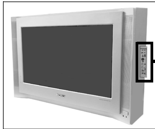
Kontrollpanelen fälls ut.
