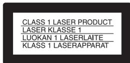
Cet appareil entre dans la catégorie des produits LASER de CLASSE 1. L'ÉTIQUETTE INDIQUANT L'APPARTENANCE DE CE LECTEUR À LA CLASSE 1 est apposée à l'arrière du boîtier.
