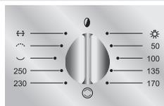
Si l'on veut différencier le chauffage, on peut activer seulement l'élément chauffant inférieur (☺) ou seulement celui du gril (☼). À la fin de la rotation se trouve le symbole ↔ qui permet d'activer le moteur du tournebroche et l'élément chauffant supérieur du gril.
