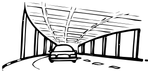
Etage inférieur d'une autoroute à deux voies superposées
