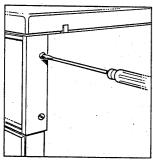
La distribution gaz est accessible en soulevant la table de travail maintenue en position horizontale par 4 vis situées aux extrémités du cadre de bandeau.
