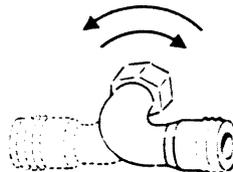
POUR SORTIE À GAUCHE : DÉVISSEZ LÉGÈREMENT TOURNEZ ET BLOQUEZ. VÉRIFIEZ L'ÉTANCHÉITÉ À L'EAU SAVONNEUSE
