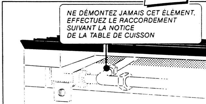
NE DÉMONTÉZ JAMAIS CET ÉLÉMENT, EFFECTUEZ LE RACCORDEMENT SUIVANT LA NOTICE DE LA TABLE DE CUISSON
