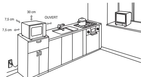
**AVERTISSEMENT :** N'installez pas le four au-dessus d'une plaque de cuisson ou de tout appareil produisant de la chaleur. S'il est installé près ou au-dessus d'une source de chaleur, le four pourra être endommagé et la garantie sera annulée.
