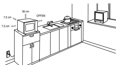
**WARNUNG:** Gerät nicht über einer Kochplatte oder einem Gerät anbringen, das Wärme abgibt. Ein Gerät, das in der Nähe oder über einer Wärmequelle installiert wird, kann dadurch beschädigt werden und die Garantie erlischt.
