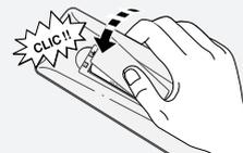
*Ne mélangez pas différents types de piles ou des piles neuves et usagées. N'utilisez pas de piles rechargeables. Afin d'éviter tout risque d'explosion, respectez les polarités indiquées au fond du compartiment à piles. Utilisez uniquement des piles du type spécifié. Ne les jetez pas au feu, ne les rechargez pas. Si vous n'utilisez pas la télécommande pendant une période prolongée, retirez les piles.*
