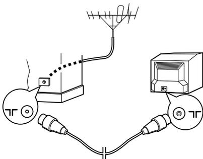
3 Branchez l'antenne extérieure ou le réseau câblé sur la prise
