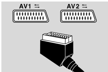
La prise **AV1** (péritélévision entrées-sorties), à l'arrière du TV/DVD, permet le raccordement d'un autre appareil : **magnétoscope** de format **VHS** ou **8 mm** ou **DVHS**, **comescope** de format **VHS** ou **8 mm**, **décodeur**, **récepteur satellite**, **lecteur DVD**, console de **jeux vidéo** ou d'appareils fournissant un signal **RVB**.
